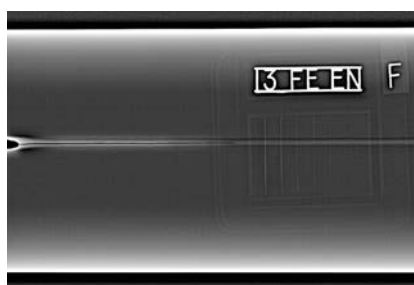
Dünnwandiger Zylinder aus Edelstahl mit Längsnaht.
